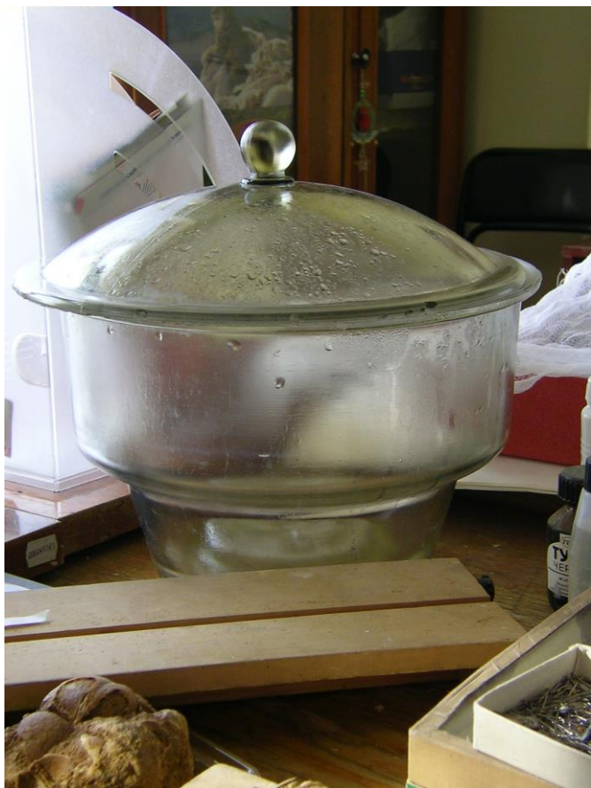
Рис. 6. Эксикатор с притертой крышкой, используется для размягчения высушенных насекомых
